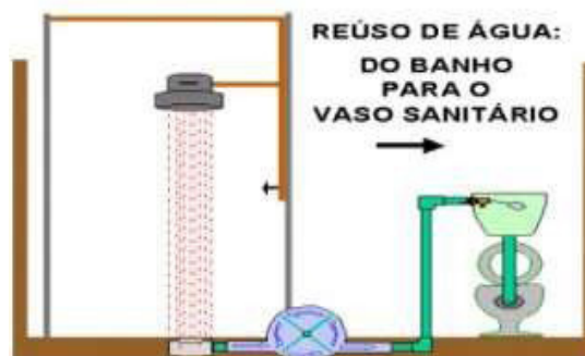
Figura 1 – Reúso da água do chuveiro
